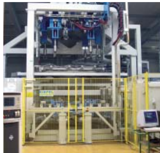
3-teilige Drehtischanlage für IMG-Anwendung und Patrize/Matrize Verformung von Composite-Materialien (Presskraft bis zu 300 to möglich)
