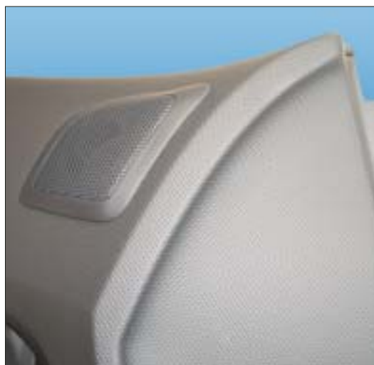
Detail Türbrüstung. Im IMG-Verfahren kaschiert
