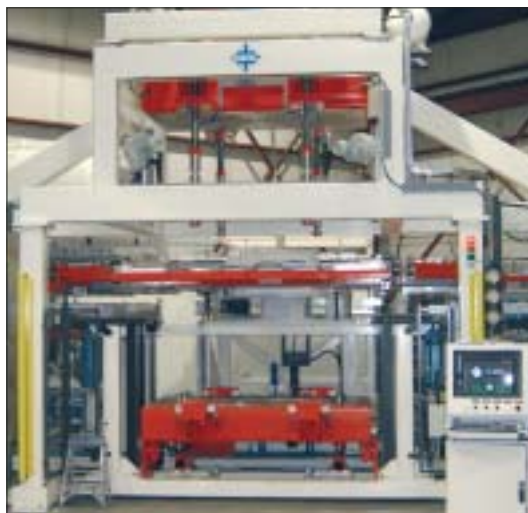
3-teilige Drehtischanlage für IMG-Anwendung und Patrize/Matrize Verformung von Composite-Materialien (Presskraft bis zu 300 to möglich)
