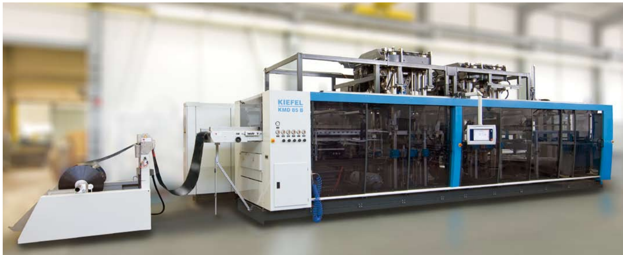
Die Anlage musste größer sein und schneller arbeiten, als die bestehende Anlage. Integriert ist eine stärkere Stanzstation. The machine needed to be larger, and with a greater operating speed, than the existing unit. A more robust cutting station is integrated into the system.
